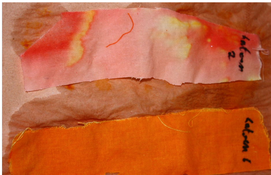
Figuur 8.4: Foto van de kleurovergang van katoen geverfd met ethyloranje (zonder toevoeging van Perfixan) bij pH 2 (boven) en pH 6 (onder)
