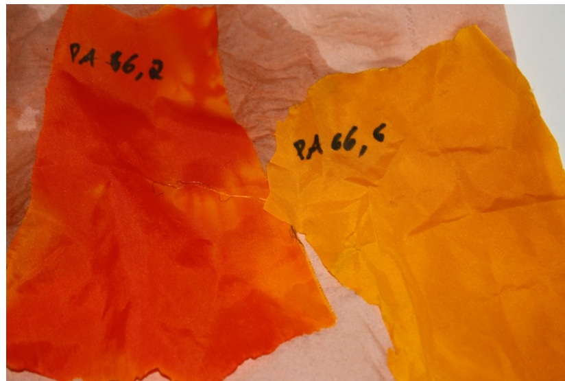
Figuur 7.6: Foto van polyamide 6.6 geïmpregneerd met ethyloranje bij pH 2 (links) en 6 (rechts)
