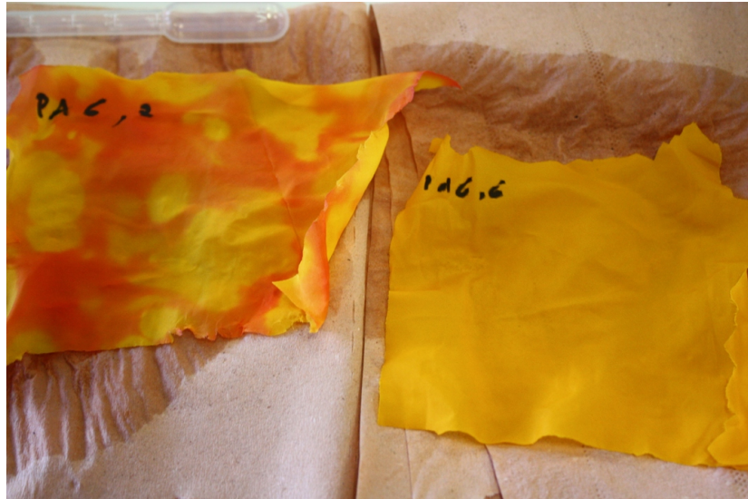
Figuur 7.4: Foto van polyamide 6 geverfd met ethyloranje bij pH 2 (links) en pH 6 (rechts)
